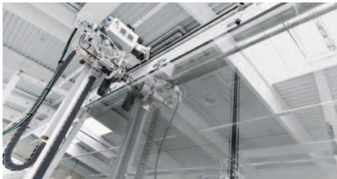
Die vollautomatisierte Fertigung umfasst auch das millimetergenaue Setzen der Abstandhalter und die Versiegelung (Bild).
