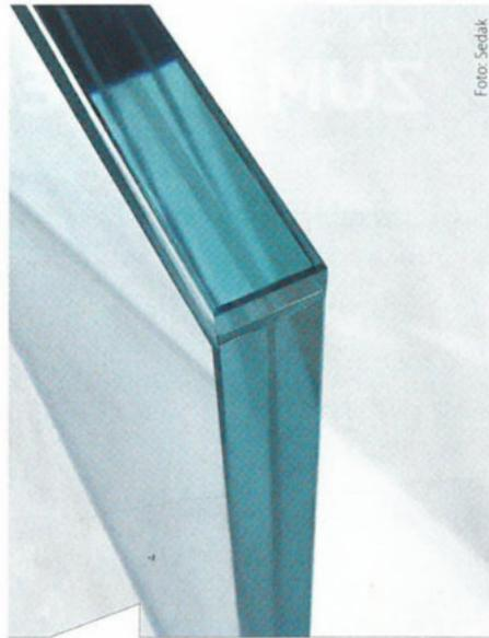
Eine Glasleiste wird als Kantenschutz auflaminiert und schließt sauber ab, schon bei dünnen 2-fach-Laminaten.
