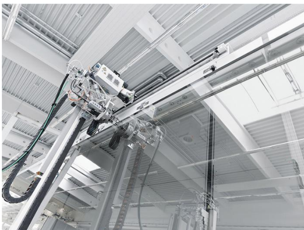
Mit High-Tech zu perfekter Ästhetik: Die vollautomatisierte Fertigung umfasst auch das millimetergenaue Setzen der Abstandshalter und die Versiegelung (Bild) – schnell, präzise, bündig. Foto: sedak GmbH & Co. KG
