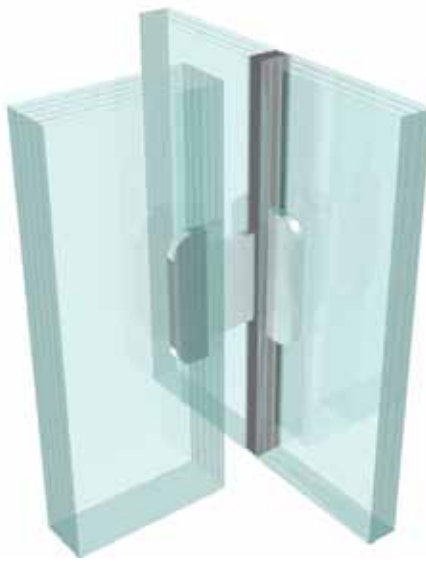
Bild 3: Retail Store New York, Prinzip Fassadendetail
