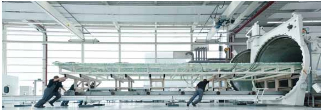
Im nach sedak Angaben weltgrößten Autoklaven für Glaslamination entstehen unter Druck und Hitze Verbundglasscheiben in Top-Qualität und enormen Größen.
