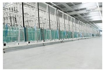
Glasfins, von sedak bis zu einer Länge von 20 Metern lieferbar, sind tragende Elemente von Ganzglasfassaden. Einen 20 Meter langen und 1,6 Tonnen schweren Glasfin zeigt sedak auf der BAU (Halle C3, Stand 100)
