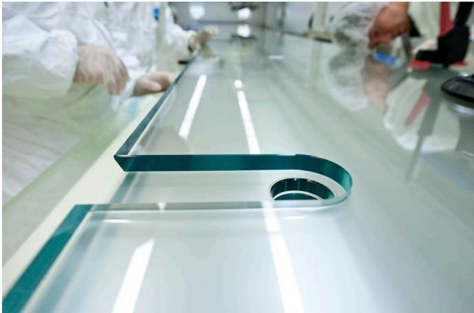
Bild 1: Unter Reinraumbedingungen werden bei sedak Gläser mit Folien zu einem Paket geschichtet.
