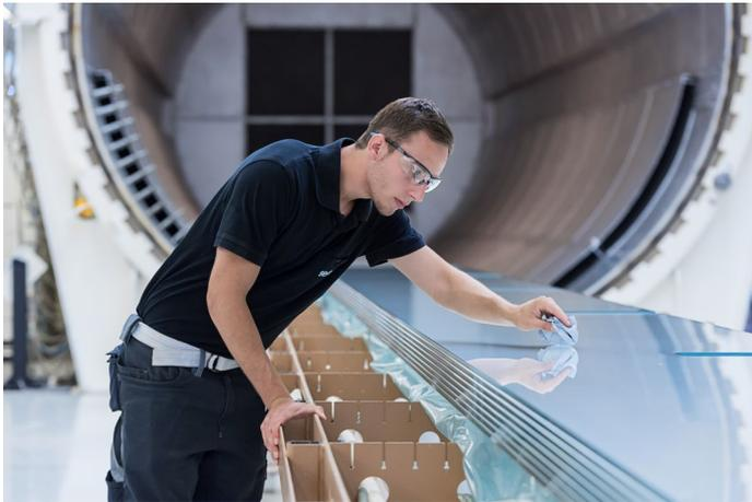
Bild 2: Bei dickeren Gläsern und vor allem bei Mehrfachlaminaten sorgt das Vakuumverfahren für Prozesssicherheit.
