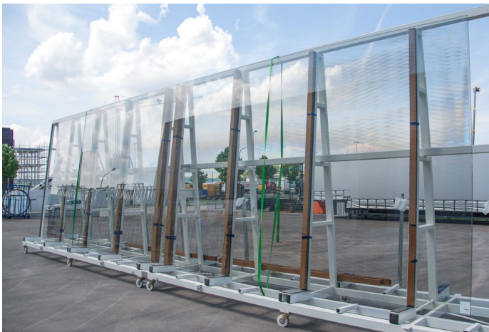
Bild 1: Musterscheibe mit auffälligen optischen Verwerfungen (Anisotropien)
